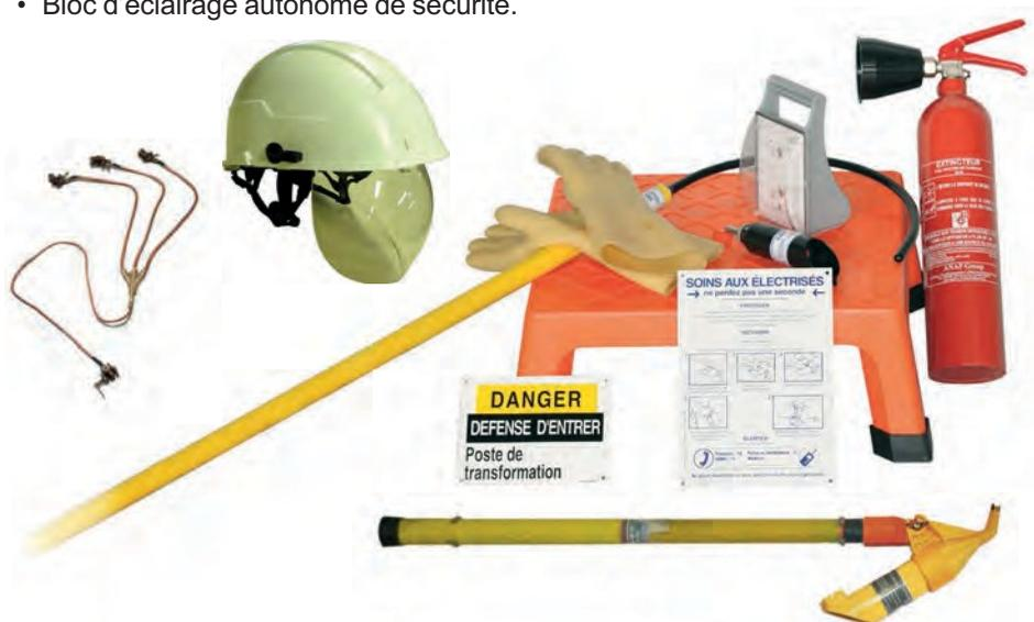
Les EPI constituent le dernier rempart en cas d'accident, ils doivent respecter les normes en vigueur, être entretenus, vérifiés/testés avant chaque usage (gants, VAT, ...).
