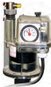
Cette huile jouant un rôle essentiel en termes de performance et de sécurité, la plupart des transformateurs sont équipés d'un dispositif de Détection Gaz – de surveillance Pression et Température (DGPT) permettant un contrôle régulier et une alerte sonore ou lumineuse. Certains dispositifs permettent une coupure automatique de la HT ou de la BT.
