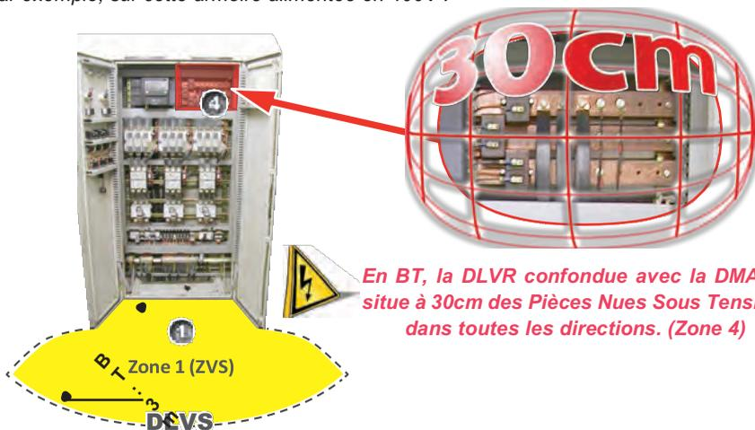
*En BT, la DLVR confondue avec la DMA se situe à 30cm des Pièces Nues Sous Tension, dans toutes les directions. (Zone 4)*
